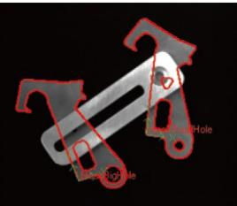
龙睿可以支持机器人视觉引导、多种运动平台定位和对位等功能，可以实现装配、上下料、打磨、涂胶、码垛、传送带跟踪、无序分拣、定位切割、打标等应用。
