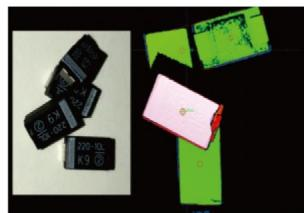
采用基于边缘轮廓的几何特征定位技术，同时结合基于区域像素分布的灰度相关性定位技术。
